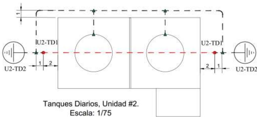
*Figura 4.18 Distribución de terminales aéreas y bajantes de puesta a tierra de tanques diarios de unidad de enfriamiento dos.*
