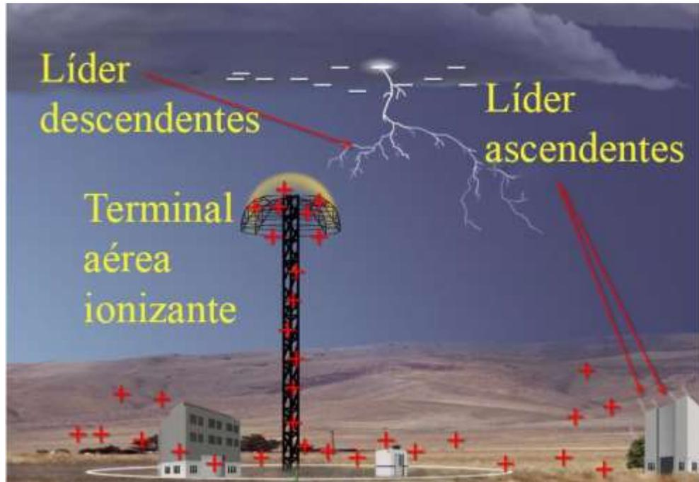
*Figura 3.4 Funcionamiento del DAS antes de un evento de rayo.*
